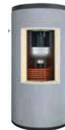
Большие резервуары для технической воды, обогреваемые несколькими источниками тепла и оснащенные дополнительным внутренним резервуаром для хранения бытовой воды. Резервуары оснащены анодной защитой, внутренней остекловкой согласно DIN 4753 и UNI 10025.
